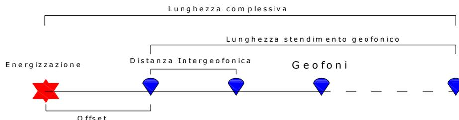
Fig.2 Schema illustrativo prova Masw
