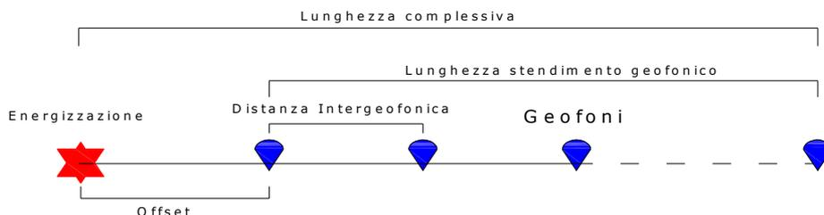
Fig.3 Schema illustrativo prova Masw
