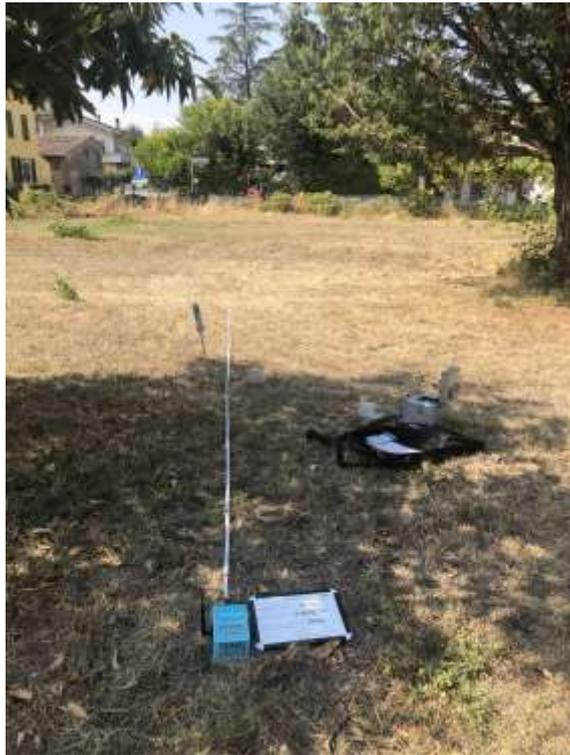
**Figura 1 Prova MASW**
